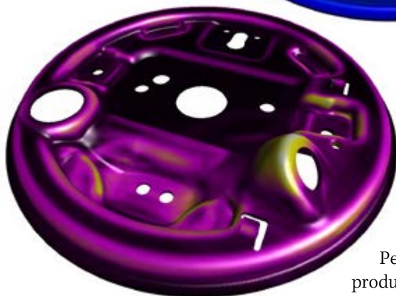
Simulazione dello stampaggio con verifica FLC, curva limite di formabilità
